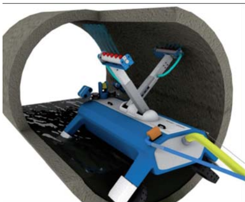
Bild 2: Reinigung von Abwasserkanälen
