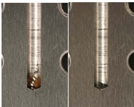
Testbohrung vor (links) und nach (rechts) der Reinigung
