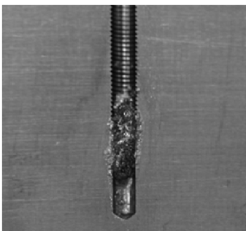
Bild 2: Verunreinigung im Bohrloch nach herkömmlicher Reinigung
